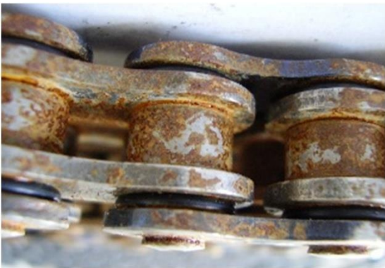
Bild 2: So abgenutzte Kette ist auszutauschen
