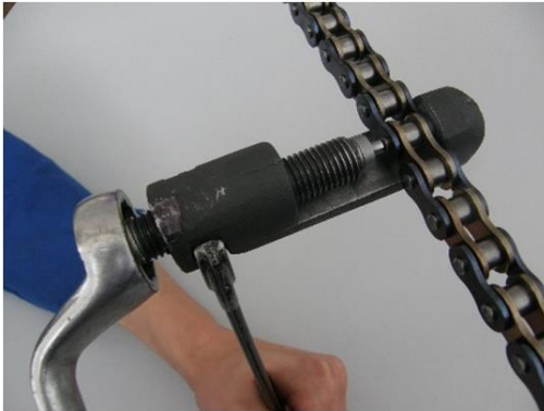
Bild 14: Montagevorrichtung VZR 6 ist zur Verkürzung von allen Kettentypen mit der Teilung von 15,875 mm geeignet.
