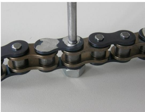
Bild 15: Die Abbildung zeigt eine Ersatzlösung wie die Kette zu trennen ist. Beschreibung der Vorgehensweise siehe Text.
