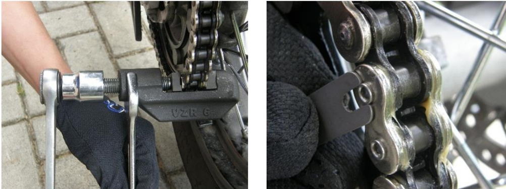
Bild 12: Für die ordnungsgemäße Installation von Rivet verwenden Verbindungsglieder Montagewerkzeug CZ VZR 6 und inklusive Messwerkzeug.
