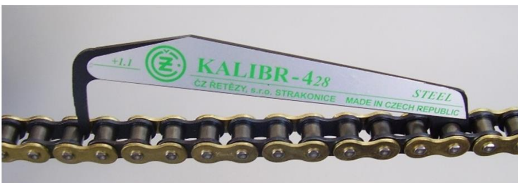
Bild 3: Messen des Abnutzungsgrads der Kette mit Prüflehre
