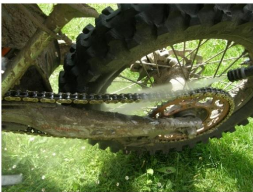
Bild 16: Durch Schlamm stark verschmutzte nichtabgedichtete, sowie abgedichtete Kette wird am besten und am einfachsten mit Druckreiniger mit kaltem Wasser ohne Reinigungsmittel gewaschen.
