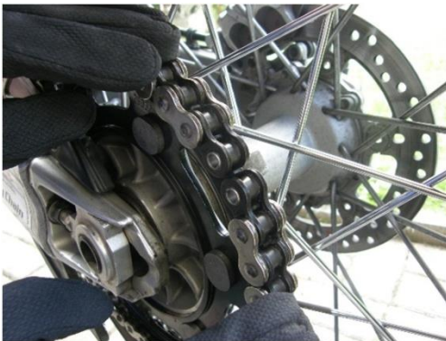
Bild 6: Zum Messen der Kettenlänge, sowie zum Einbau des Verbindungsglieds ist es zweckvoll, die Kettenenden an das Kettenrad zu geben.
