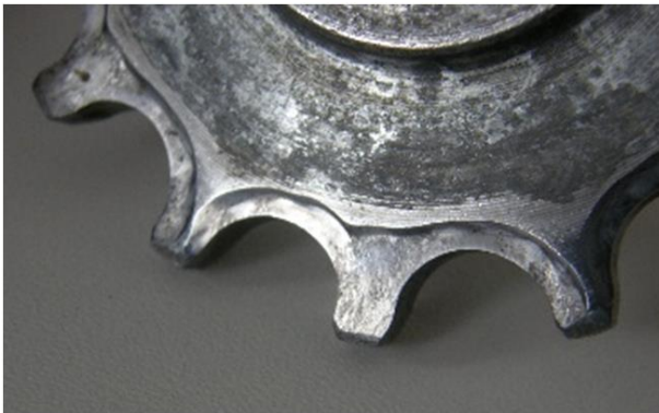
Bild 8: Es ist unzulässig, verschlissene und verformte Zähne des Kettenrads zusammen mit neuer Kette einzubauen.
